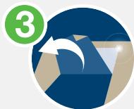
Zum Entfernen des Schutzlacks einfach an einer geeigneten Stelle (z.B. Ecken oder Kanten) anheben und abziehen oder mit Wasser anfeuchten und abziehen.
