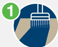
Abhängig von Untergrund und Verschmutzungsgrad benötigen Sie ca. 0,2 l/m<sup>2</sup>. EnProtect gleichmäßig mit Pinsel, Rolle oder Sprühpistole auftragen.
