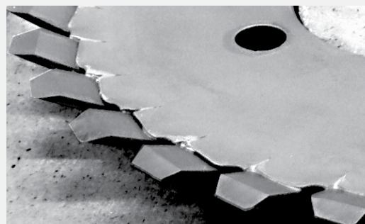
TKM Schnitzelfräser mit Einweg Hartmetall (HM)-Segmenten (geschraubt)
